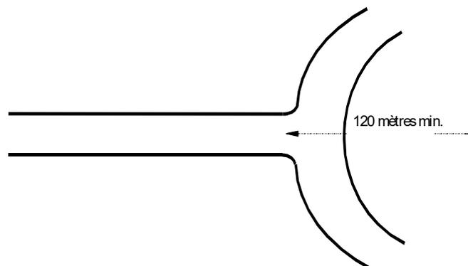
Figure : Rayon de courbe minimal à proximité d'une intersection
