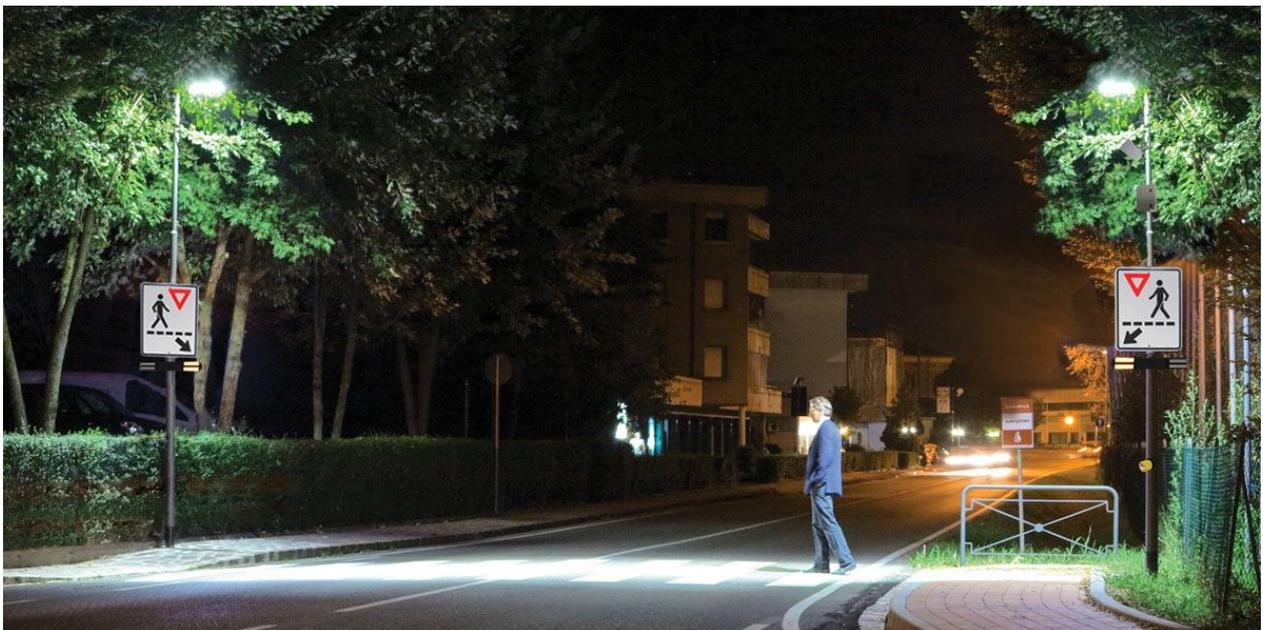
Figure 4.12 : Exemple de feux rectangulaires à clignotement rapide (FRCR) activés par les piétons et éclairage ciblé du passage piéton (photo : Trafic innovation)
